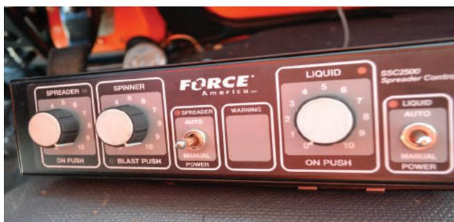
Автоматическое управление количеством разливаемого материала осуществляется с пульта управления распределением противоголедных материалов или с дополнительного пульта, который может быть установлен по желанию заказчика.
