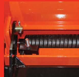
Откидная подпружиненная ножевая полоса, регулируемые по высоте опоры и 5 регулируемых торсионных пружин
