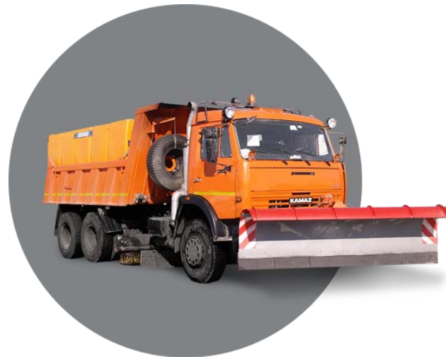
КОМБИНИРОВАННАЯ ДОРОЖНАЯ МАШИНА НА САМОСВАЛЕ КАМАЗ
