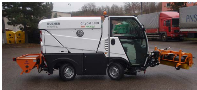
CC 1000 с фронтальной цилиндрической щеткой и посыпателем ПГМ
