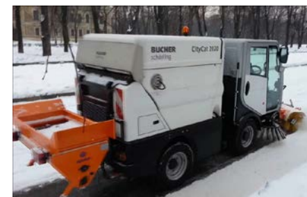
CC 2020 с фронтальной цилиндрической щеткой и посыпателем ПГМ
