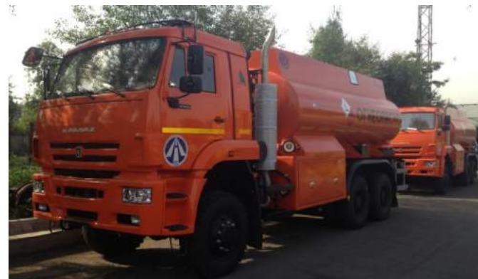
БЦМ-229.4 НА ШАССИ КАМАЗ 65225
