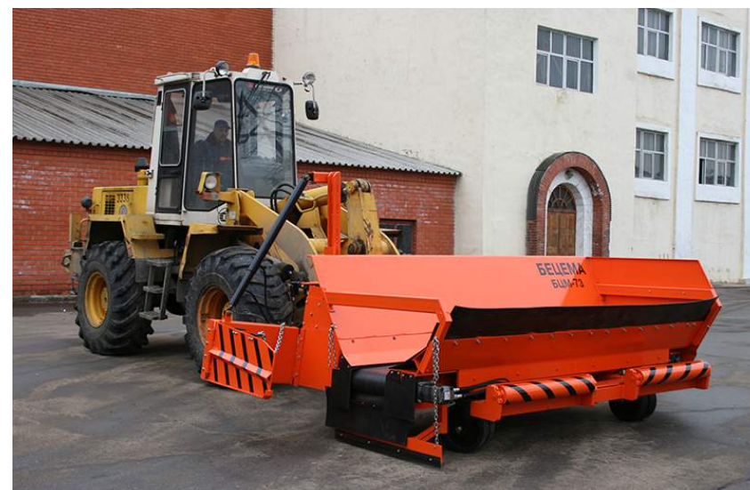
Комплект оборудования для отсыпки обочин БЦМ-73
